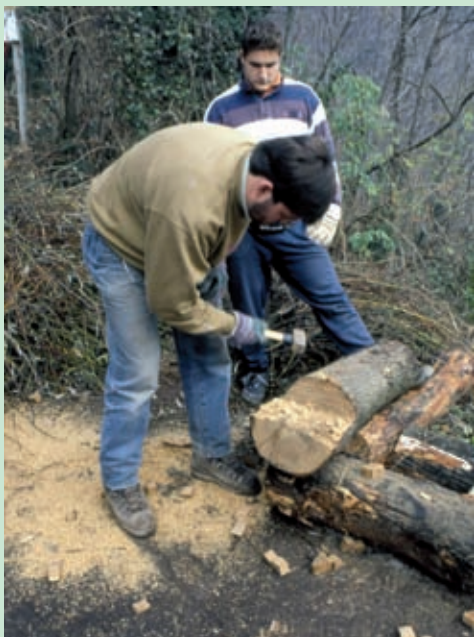
Rifinitura grossolana mediante mazzetta o coltello pesante (Foto R.Ferrari).
