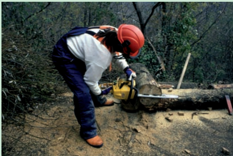
Piccola incisione parallela all'asse longitudinale del tronco per una profondità di 1-2 cm, tale da permettere l'inserimento del cuneo di ferro (Foto R.Ferrari).
