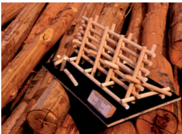
A sinistra: Palificata viva Roma (di versante). Modellino riprodotte la struttura lignea portante della tipologia (prospettiva) (Foto R.Ferrari). A destra: Palificata viva Roma (di versante). Modellino riprodotte la struttura lignea portante della tipologia (vista frontale) (Foto R.Ferrari).
