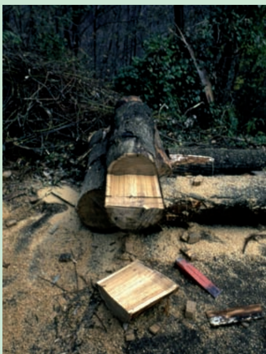
Percussione mediante mazza del cuneo di ferro sino al distacco della porzione semicilindrica del tronco (Foto R.Ferrari).
