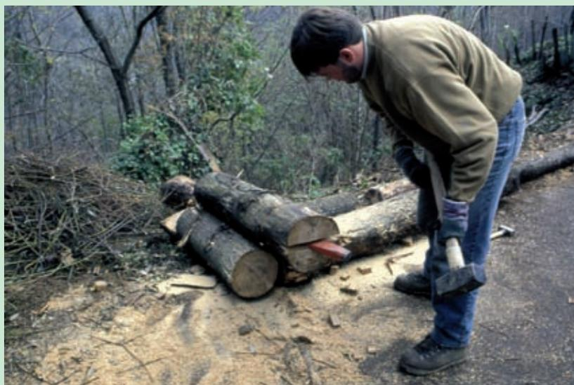
*Percussione mediante mazza del cuneo di ferro sino al distacco della porzione semicilindrica del tronco (Foto R.Ferrari).*
