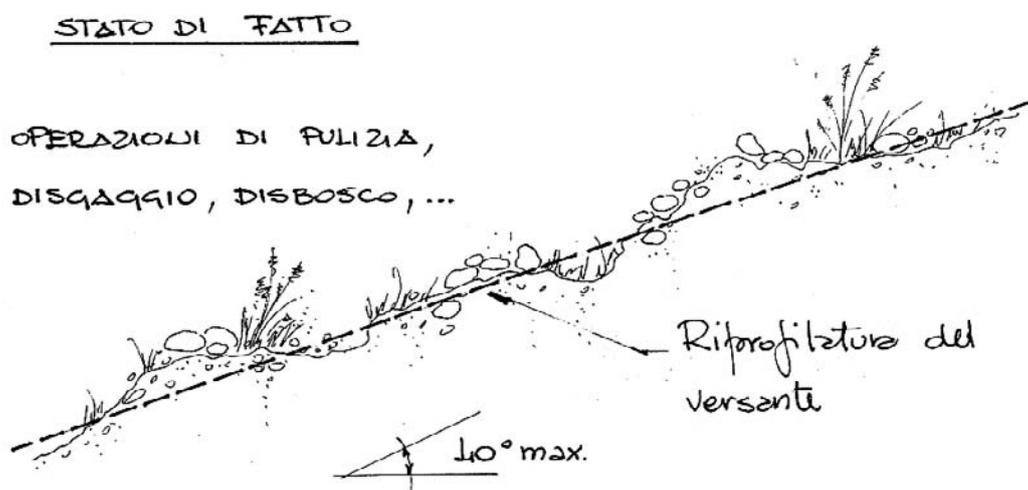
Dis. 1 – Fascinata viva (di versante). Fase 1 - Ipotetica situazione di dissesto con evidenziati gli elementi morfologici più caratteristici e le operazioni da eseguirsi (in tratteggio la riprofilatura ed il rimodellamento del versante) (sezione).
