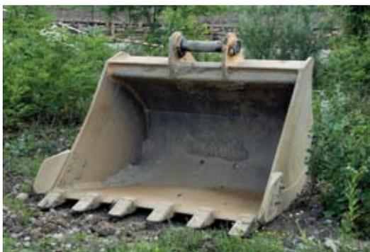
A sinistra: Attrezzature, Attrezzature per scavo. Macchine movimento terra, Tipi di benne. Benna larga per movimentazioni grossolane di grandi quantità di materiale inerte (Foto R.Ferrari).
