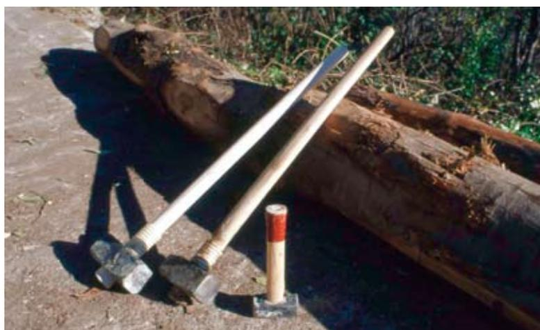
Attrezzature, Attrezzature per infissione. Mazze, Mazzetta manico corto (1,5 kg) e mazza manico lungo (5 kg). Tipi di mazze più frequentemente utilizzate (Foto R.Ferrari).
