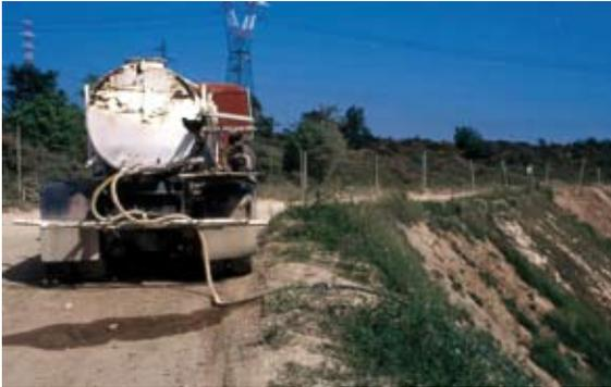
*Attrezzature, Attrezzature particolari. Botte per acqua montata su autocarro pesante adibita ad irrigazione in intervento di manutenzione (Foto R.Ferrari).*
