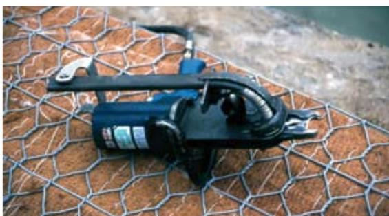
Attrezzature, Attrezzature particolari. Pinzatrici idrauliche. Pinzatrice idraulica adibita al montaggio della parte strutturale di Terra rinforzata rinverdita in rete metallica a doppia torsione (Foto R.Ferrari).
