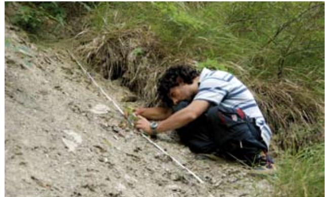
*A sinistra: Attrezzature, Attrezzature per il rilevamento speditivo in campagna, controllo in cantiere, monitoraggio. Clinometri. L'inclinazione (pendenza) del substrato e/o delle strutture portanti molto spesso è decisivo per la scelta della tipologia (Foto R.Ferrari).*
