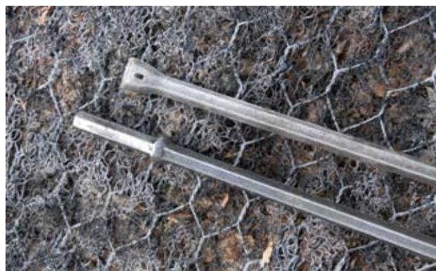
Attrezzature, Attrezzature per perforazione. Perforatrici ad aria, Tipi di punte di perforazione per roccia. Punta di perforazione specifiche per roccia (Foto R.Ferrari).
