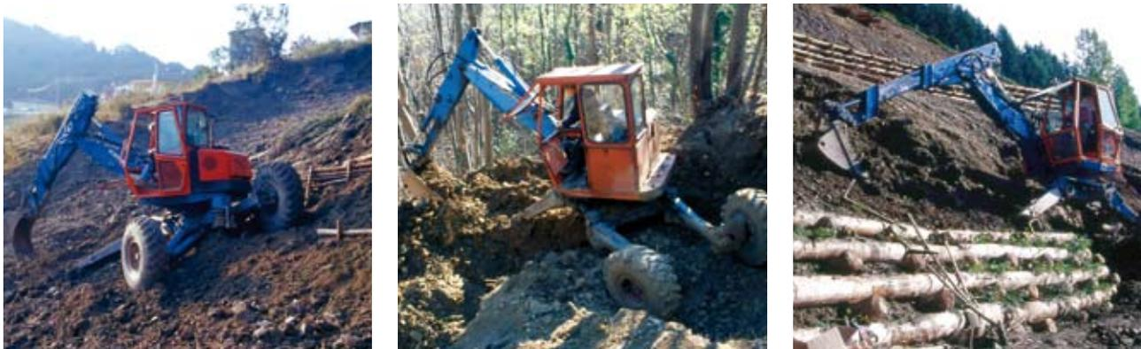
A sinistra: Attrezzature, Attrezzature per scavo. Macchine movimento terra, Ragni meccanici. Ragno meccanico adibito a riempimento di Palizzata viva (Foto R.Ferrari).
