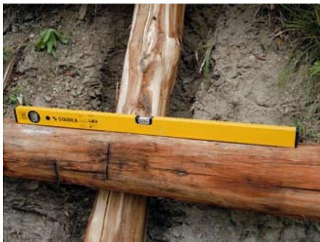
*Attrezzature, Attrezzature per il rilevamento speditivo in campagna, controllo in cantiere, monitoraggio. Livelle a bolla. L'utilizzo consente il controllo della precisione necessaria in alcune fasi costruttive (Foto R.Ferrari).*
