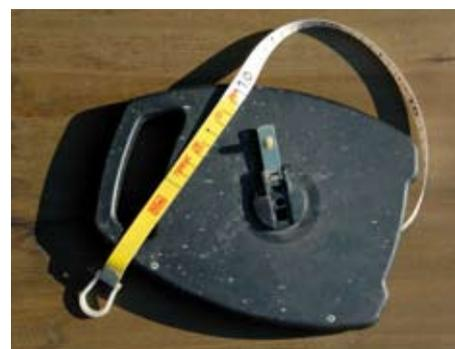
*Attrezzature, Attrezzature per il rilevamento speditivo in campagna, controllo in cantiere, monitoraggio. Cordelle metriche. Generalmente le lunghezze utili possono variare tra 20÷50 m (Foto R.Ferrari).*
