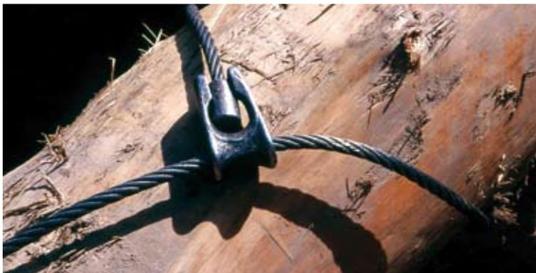
*Attrezzature, Attrezzature per movimentazione. Braghe, catene, ganci. Braga in fune d'acciaio adibita a movimentazione di tonde di grosso diametro (Foto R.Ferrari).*
