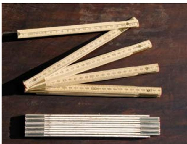
*Attrezzature, Attrezzature per il rilevamento speditivo in campagna, controllo in cantiere, monitoraggio. Metri snodabili. Generalmente la lunghezza standard è 2 m (Foto R.Ferrari).*
