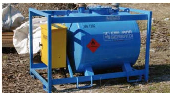
Attrezzature, Attrezzature per supporto. Contenitori per liquidi. Serbatoio per carburante di grandi dimensioni elitrasportabile (Foto R.Ferrari).
