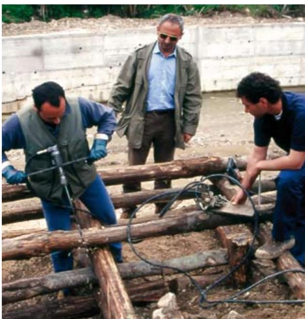
*Attrezzature, Attrezzature per perforazione. Trapani idraulici. Prototipo sperimentale di fabbricazione artigianale (Foto R.Ferrari).*
