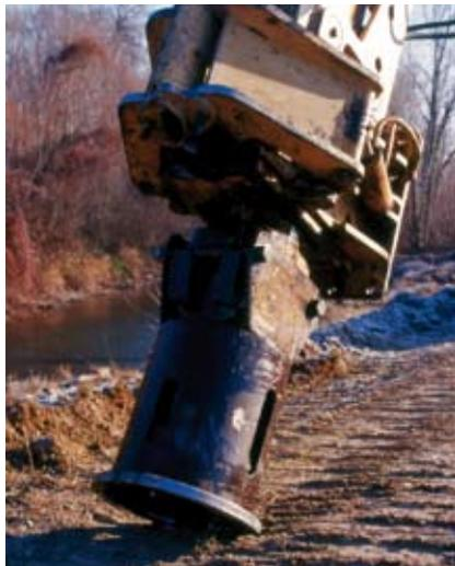
A sinistra: Attrezzature, Attrezzature per infissione. Battipali. Testa battipalo applicata a scavatore meccanico (Foto R.Ferrari).
