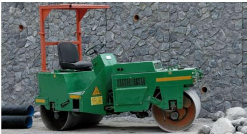
A sinistra: Attrezzature, Attrezzature particolari. Compattatori, Rulli. Rullo. (Foto R.Ferrari).
