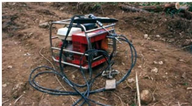
Attrezzature, Attrezzature per supporto. Centraline idrauliche. Centralina oleodinamica sperimentale di fabbricazione artigianale (Foto R.Ferrari)
