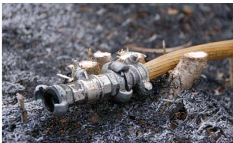
Attrezzature, Attrezzature per supporto. Raccordi pneumatici. Raccordo pneumatico dotato di valvola (Foto R.Ferrari).
