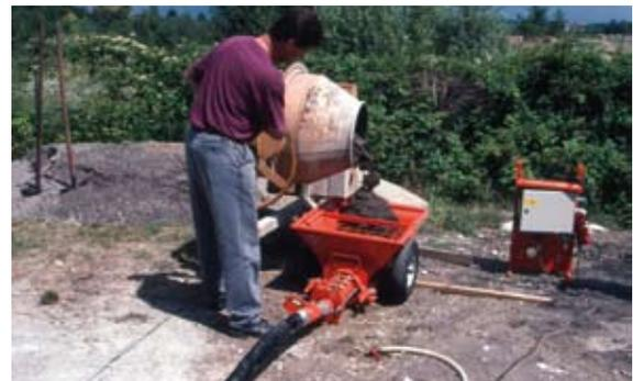
Attrezzature, Attrezzature particolari. Pompe per materiali viscosi. Caricamento di pompa per materiali viscosi (Foto R.Ferrari).
