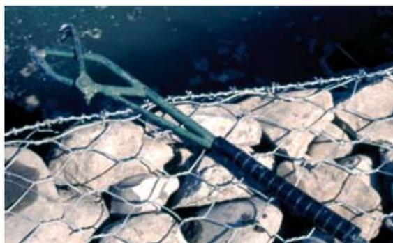
Attrezzature, Attrezzature particolari. Leve tendi-reti. Leva tendi-rete adibita a chiusura di gabbioni in rete metallica (Foto R.Ferrari).
