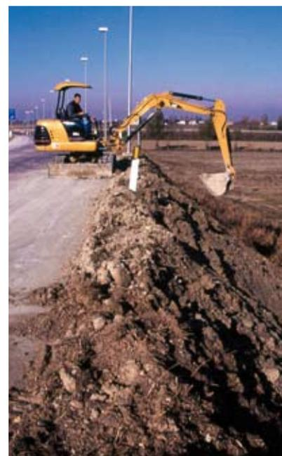
**A sinistra: Attrezzature, Attrezzature per scavo. Macchine movimento terra, Scavatori meccanici.** Mini scavatore meccanico cingolato adibito al prelievo di cespi di PHRAGMITES AUSTRALIS (Foto R.Ferrari).
