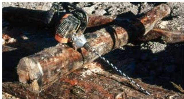
*A sinistra: Attrezzature, Attrezzature per perforazione. Trapani a motore a scoppio. Trapano a motore a scoppio (Foto R.Ferrari).
