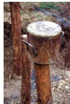
Attrezzature, Attrezzature particolari. Calotte metalliche di protezione testa palo. Calotta metallica di protezione testa palo posizionata su tronco di grande diametro (Foto R.Ferrari).
