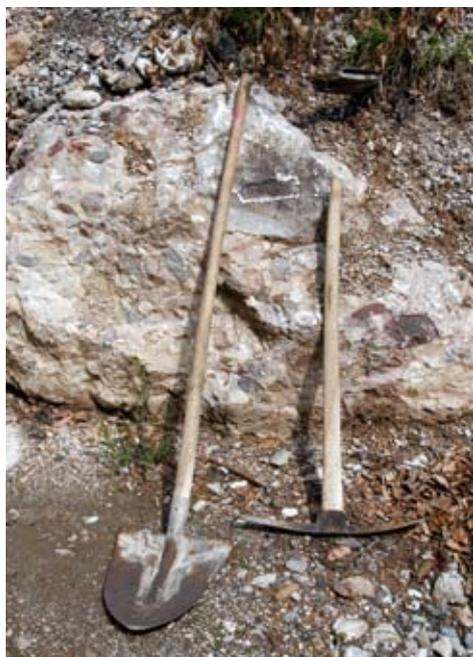
Attrezzature, Attrezzature per scavo. Picconi. Assieme alle pale costituiscono l'attrezzatura classica di base per ogni tipologia di scavo (Foto R.Ferrari).
