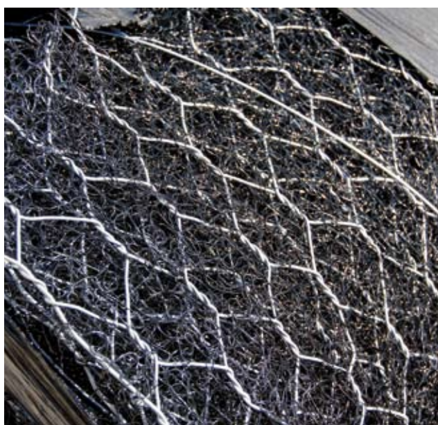
A sinistra: Materiali. Fibre sintetiche; georete tridimensionale in fibre sintetiche unita a rete metallica a doppia torsione zincata (Foto R.Ferrari).
