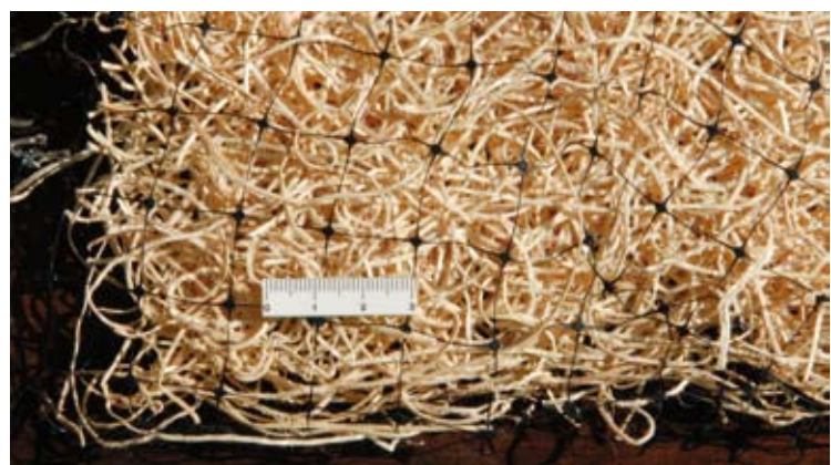
A sinistra: Materiali. Fibre vegetali; biofeltro in fibre di paglia contenuto da rete in materiale sintetico degradabile (recto) (Foto R.Ferrari).
