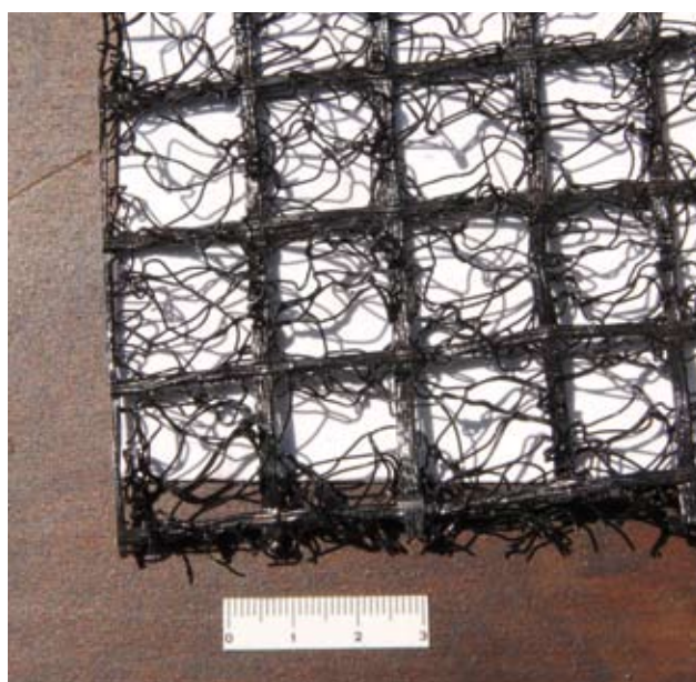
A sinistra: Materiali. Fibre sintetiche; georete tridimensionale in fibre sintetiche unita a rete metallica a doppia torsione zincata (Foto R.Ferrari).
