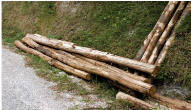
Materiali. Tondame di grande diametro ( \emptyset > 15 cm); tronchi di castagno scortecciati (Foto R.Ferrari).
