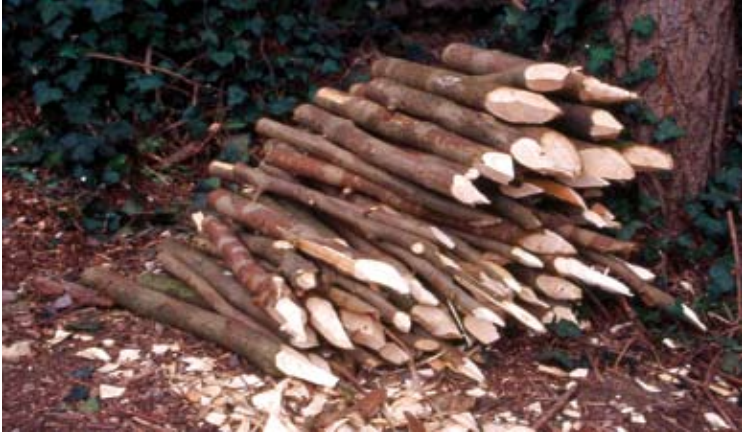
Materiali. Elementi di fissaggio struttura-substrato; picchetti in parti legnose (Foto R.Ferrari).
