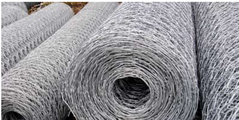
Materiali. Reti metalliche; rotoli di rete metallica a doppia torsione zincata (Foto R.Ferrari).
