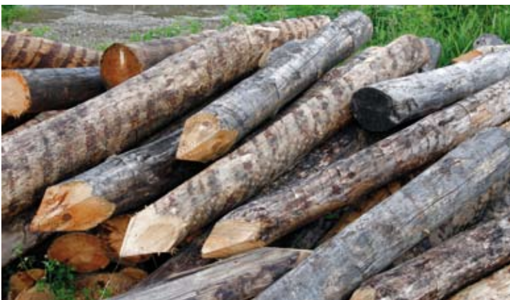
Materiali. Tondame di grande diametro ( \emptyset > 15 cm); tronchi di pino nero con punta ad una estremità (Foto R.Ferrari).
