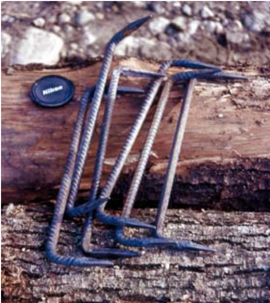
Materiali. Elementi rigidi di fissaggio provvisorio legno-legno; cambre (o zanche o grappe) in tondino di ferro ad aderenza migliorata (Foto R.Ferrari).
