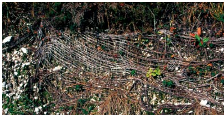
Materiali. Fibre vegetali; naturale degradamento di biostuoia in fibre di juta (Foto R.Ferrari).
