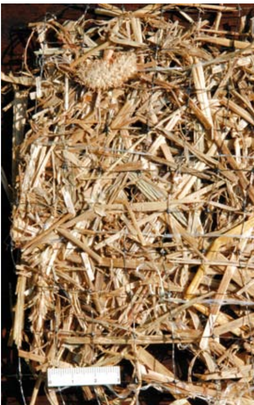
A sinistra: Materiali. Fibre vegetali; biofeltro in fibre di paglia contenuto da rete in materiale sintetico degradabile (recto) (Foto R.Ferrari).
