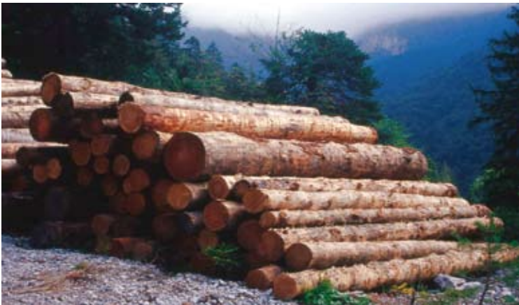
Materiali. Tondame di grande diametro ( \emptyset > 15 cm); tronchi di larice (Foto R.Ferrari).
