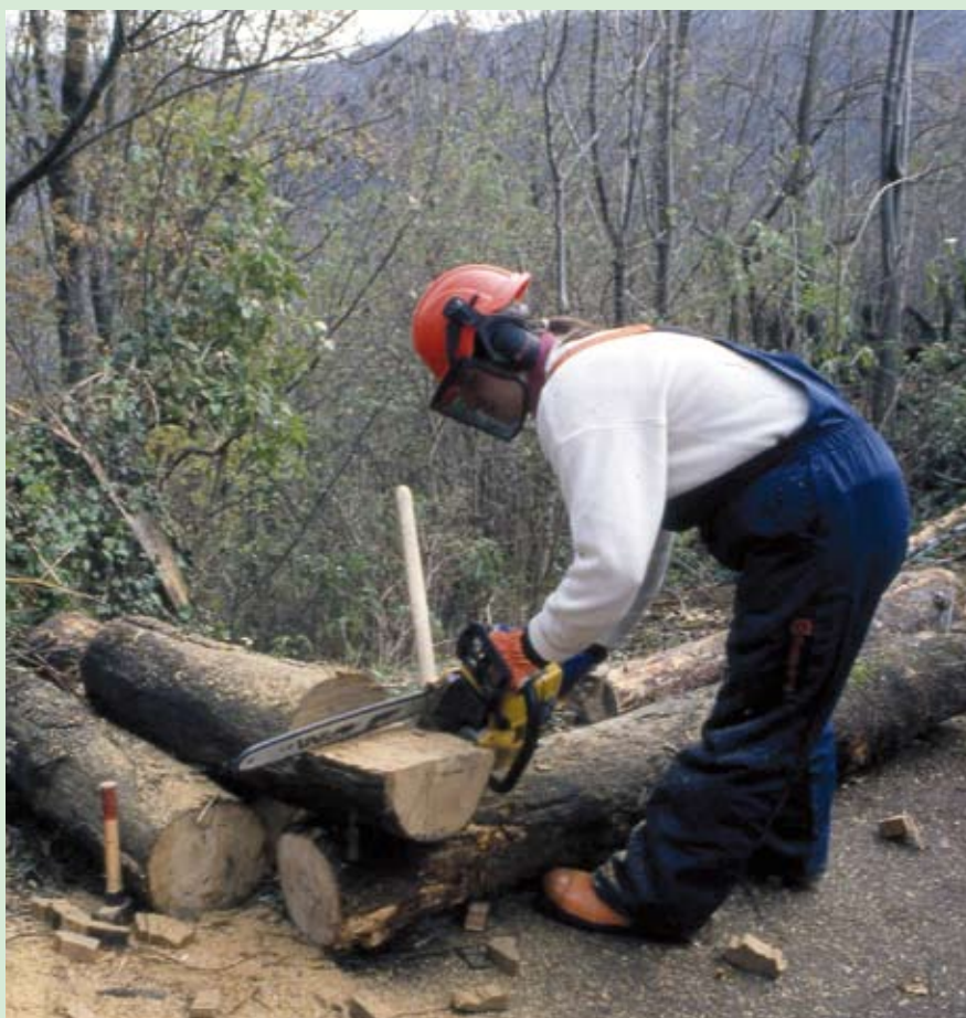
Taglio parallelo all'asse longitudinale del tronco sino all'intersecazione con il taglio precedente (Foto R.Ferrari).
