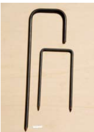
Materiali. Elementi rigidi di fissaggio struttura-substrato; picchetti (segmenti) in tondino di ferro variamente sagomati (Foto R.Ferrari).
