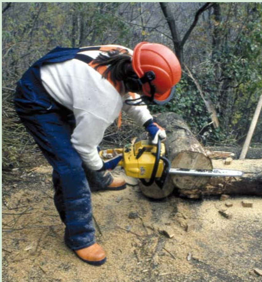
Taglio parallelo all'asse longitudinale del tronco sino all'intersecazione con il taglio precedente (Foto R.Ferrari).
