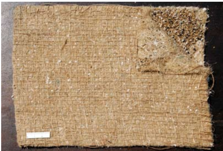
Materiali. Fibre vegetali; biofeltro in fibre di juta contenuto da biostuoia in fibra di juta preseminato e concimato (recto) (Foto R.Ferrari).
