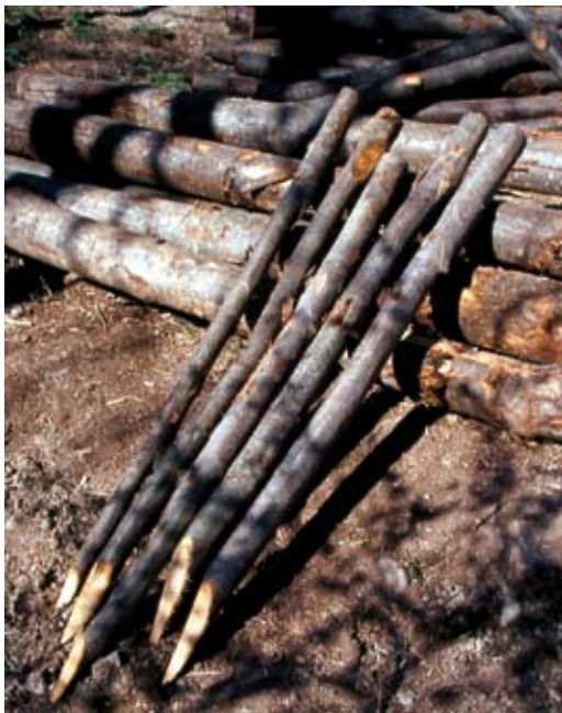
A sinistra: Tondame di piccolo diametro (Ø 8÷15 cm): tronchi di castagno (Foto R.Ferrari).
