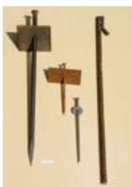
Materiali. Elementi rigidi di fissaggio struttura-substrato; elementi di contrasto (Foto R.Ferrari).
