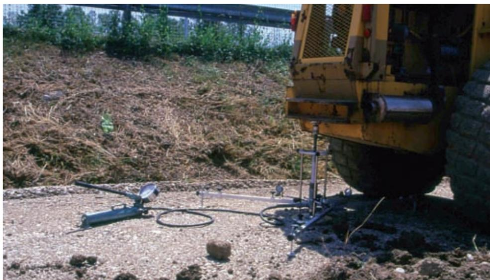
Terra rinforzata rinverdita (di versante), Gruppo D. Esecuzione di prova geotecnica in situ (Prova di carico su piastra) per la verifica dei parametri di compattazione del materiale inerte di riporto utilizzato per il riempimento (in opera) (Foto R.Ferrari).
