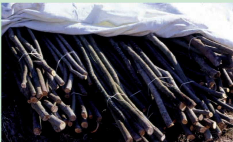
Stoccaggio in cantiere di materiale vegetale vivo (astoni) riparato da soleggiamenti, gelate e ventilazioni eccessivi (Foto R.Ferrari).
