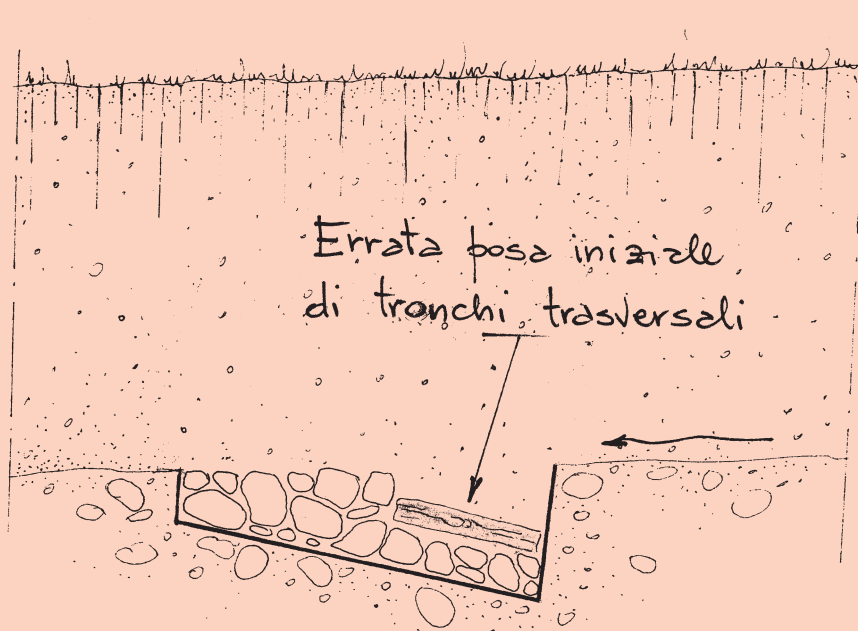
Dis. 11 – Briglia viva in legname e pietra. Fase 4 - Errata posa iniziale di tronchi trasversali (sezione).
