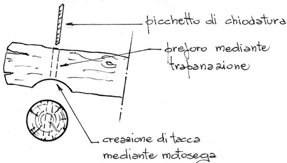
Dis. 16 - Briglia viva in legname e pietrame. Fase 5 - Realizzazione di tacca per sopperire a diametro troppo grosso (particolare; sezione).
