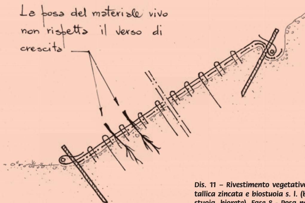
Dis. 11 – Rivestimento vegetativo in rete metallica zincata e biostuoia s. l. (biofiltro, biostuoia, biorete). Fase 8 - Posa non rispettosa del verso di crescita del materiale vegetale vivo (sezione).
