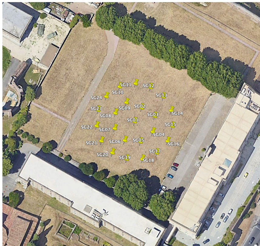
Figura 2 – Vista in pianta della configurazione dell'array circolare (array GE).
