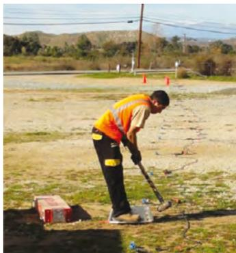
Piastra in alluminio con martello come sorgente sismica dell'onda di taglio.
