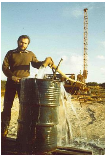
Foto 1 - Prova di portata su acquifero carsico; la portata della pompa è misurata mediante un recipiente di volume noto di 220 l (Cirenaica, Libia)
